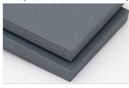
폴리염화 비닐(Polyvinyl chloride, PVC)은 열가소성 플라스틱의 하나로 강하고, 색을 내기 쉬운 특징을 갖고 있습니다. 단단하면서도 유연한 소재이며, 잘 마모되지 않는 성질이 있으나 열에는 약한 편입니다. 주로 파이프, 전기절연체, 바닥재에 사용합니다.
