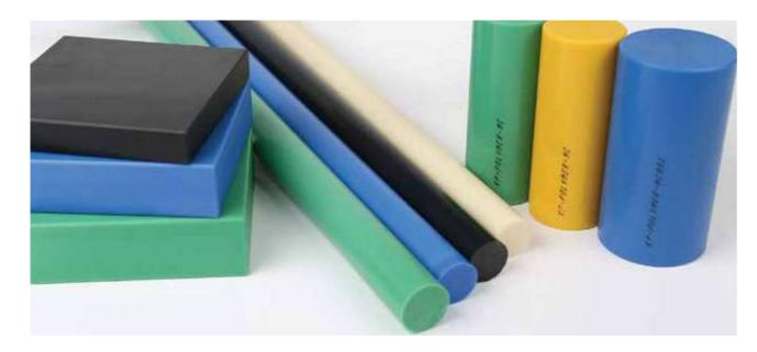
개 요 NYLON-6의 단량체인 카프로락탐을 직접 주형에 주입한 상태로 음이온 중합시켜 제조되는 산업용 수지로서 종래의 일반 NYLON-6의 사출성형이나 압출성형과는 화학적으로 동일하나 분자량이 훨씬 크고 결정화도가 매우 우수합니다.
