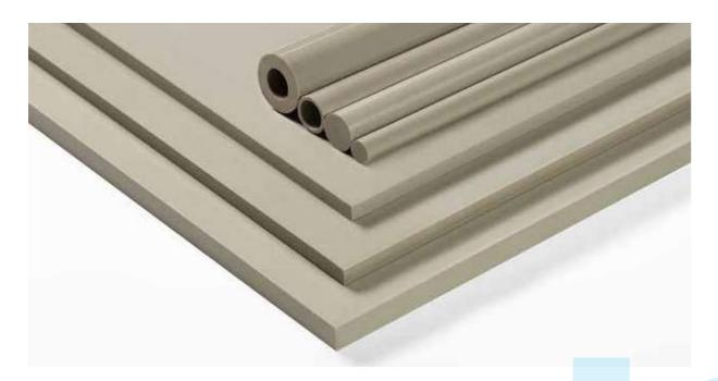
개 요 PEEK는 Polyether ether ketone 수지를 압출성형한 열가소성 고기능 플라스틱으로, PPS(Polyphenylene sulfide) 와 유사한 내약품성, 내수분성을 가지고 있지만 PPS(220°C/426°F)보다 높은 연속사용온도 (250°C/480°F)를 가지고 있습니다. 난연 등급이며, 뜨거운 물이나 수증기 등 고강도의 열악한 작업 환경에서도 물리적 성질을 잃지 않아 전기, 전자, 항공 등 분야에 광범위하게 사용됩니다.
