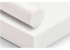
테프론(PTFE) 소재는 대단히 높은 열안정성과 내화학성, 그리고 높은 융점(-200~+260°C, 단기사용: 300°C)을 가지는 결정성 소재입니다. 슬라이딩 특성이 매우 우수하며, 높은 전기 저항성 및 비 첨착성 표면의 특성을 가지고 있습니다. 반대로 낮은 기계적 강도와 다른 소재에 비해 높은 비중을 가지며, 기계적 특성을 향상시키기 위해서 유리섬유나 탄소섬유를 첨가제로 사용하여 보강할 수 있습니다.
